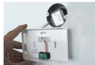
svorkovnice pro drátové připojení wired connection terminal box Klemmenleiste für den kabelgebundenen Anschluss
