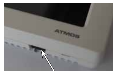
napájecí konektor power connector Einspeise-Steckverbinder (Ø5,5/Ø2,1 mm) 12VDC
