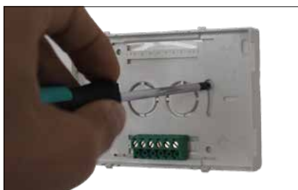
Fixation de la carte d'installation de la passerelle
