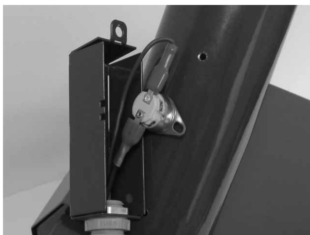
Obr. 10 - bezpečnostní termostat na trubce pro přívod pelet 95 °C (55 °C pro kotle DxxPX, PXxx)
