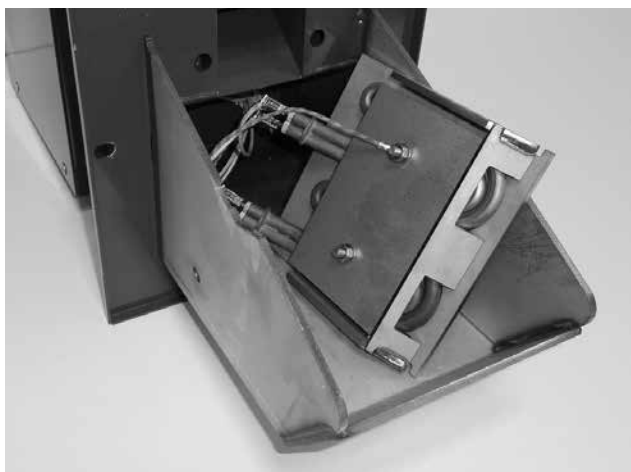
Obr. 3 - demontovaná deska se 2 zapalovacími spirálami
