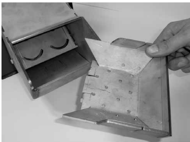
Obr. 1 - vyjímatelná spalovací komůrka - nutno pravidelně čistit
