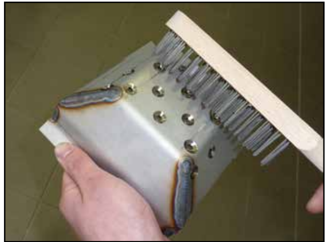
Reinigung der Brennkammer
