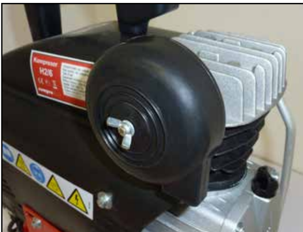
Auf dem Verdichter befestigter Saugfilter
