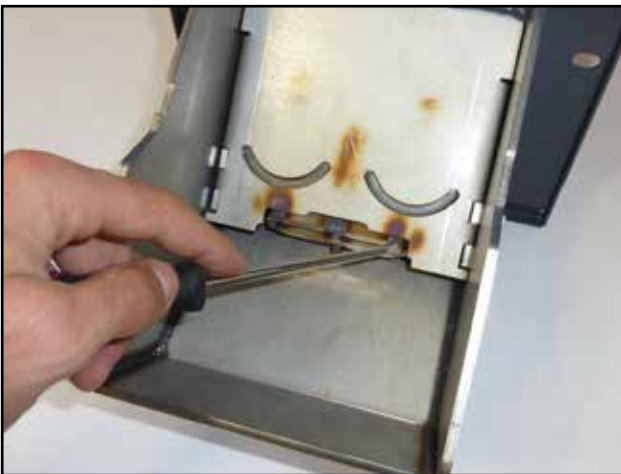
Die Platte der Glühspiralen wird zurückgelegt und der Kanal für pneumatische Reinigung in der entsprechenden Vertiefung zentriert
