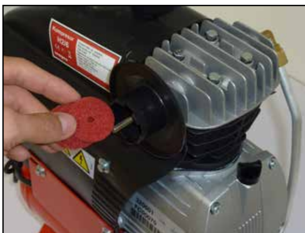
Reinigung des Verdichterfilters
