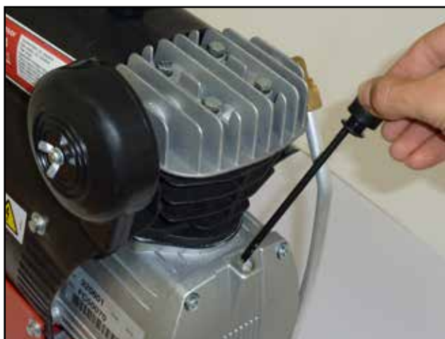
Prüfung des Ölstands im Verdichter
