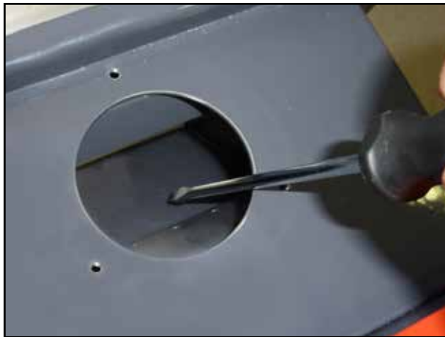
Ukázka čištění prostor pod přívodní trubicí pelet
