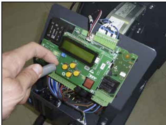
Ukázka čištění (vyfoukání) prostoru uvnitř hořáku. (bez el. proudu!)
