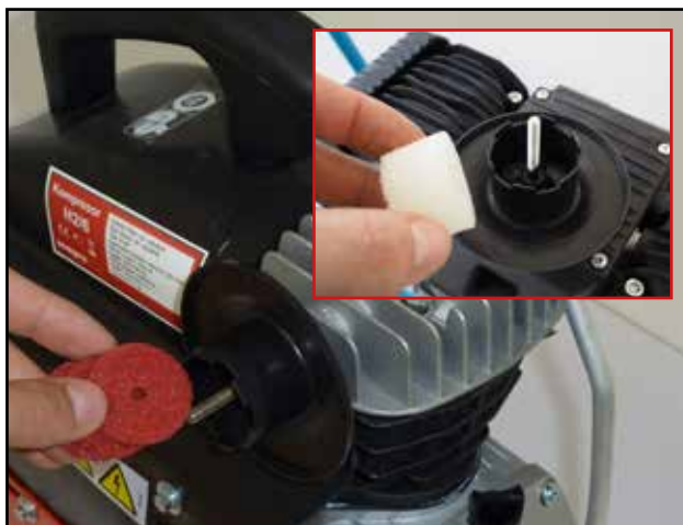
Ukázka čištění filtru kompresoru
