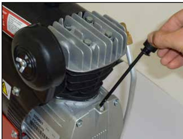
Ukázka kontroly olejové náplně v kompresoru
