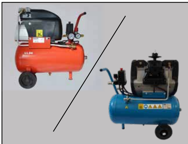
Upravený kompresor pro účely pneumatického čištění
