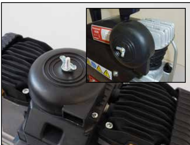
Foto sacího filtru našroubovaného na kompresoru
