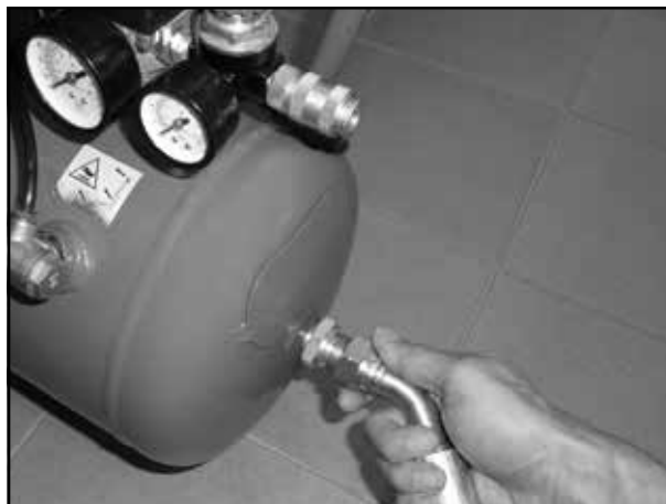
Anschluss des Verbindungsschlauches (3/4“) an den Kompressor und an die komplette Verschraubung mit dem Elektroventil am Brenner
