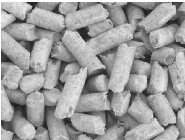
Hochwertige Holzpellets – Weißpellets ohne Schwarzkpunkte (Rinde)
