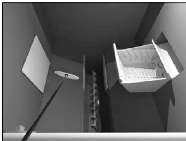
Schieben der Asche in den unteren Bereich an die Schnecke für die automatische Ascheentleerung
