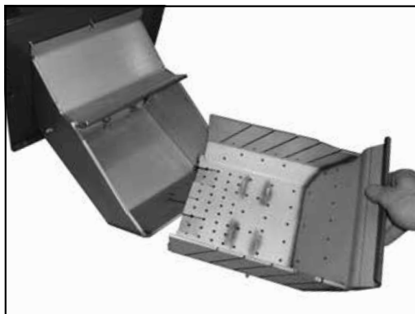
Herausnahme der Verbrennungskammer aus dem Brenner
