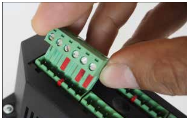
Uwaga – złącza wyposażone są w piny zapobiegające ich zamianie na listwie zaciskowej
