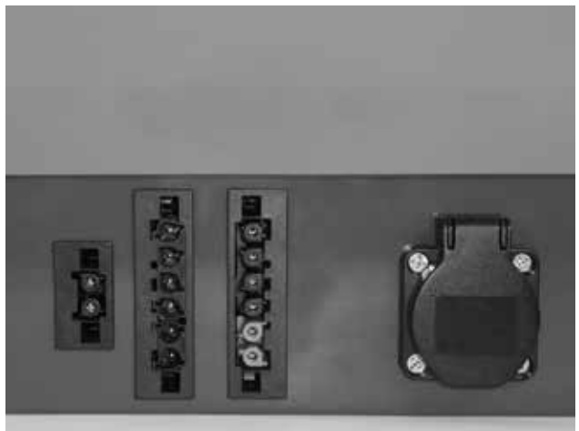
Abb. 12 - Brenner / zwei 6 Pin-konnektore,- links Spannung, rechts Fühler, zusätzliches Kabel mit 2-Pin-Stecker (R3 und R4) und Steckdose für Förderschnecke
