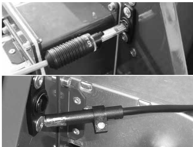
Abb. 6 - Photozelle - Vorsicht auf richtige Orientierung – es wird empfohlen, die Zelle mindestens einmal jährlich zu reinigen neue Fotozelle / alte Fotozelle
