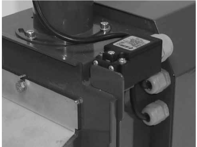
Abb. 8 – Endschalter mit Spezialanschlag
