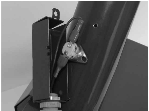
Abb. 10 - Sicherheitsthermostat am Rohr für Pelletzufuhr 95 °C
