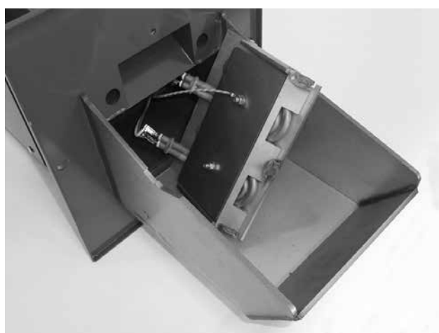
Obr. 4 - demontovaná deska se 2 zapalovacími spirálami
