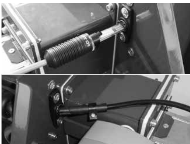
Obr. 6 - fotocela - pozor na správnou orientaci - doporučujeme minimálně jednou ročně očistit nová fotocela / stará fotocela
