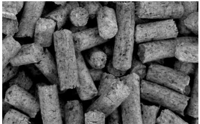
Holzpellets schlechter Qualität – Dunkelpellets mit Rinde (mit schwarzen Punkten)
