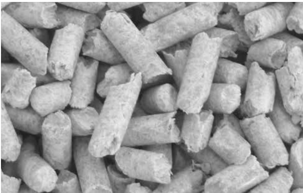
Hochwertige Holzpellets – Weißpellets ohne Schwarzpunkte (Rinde)
