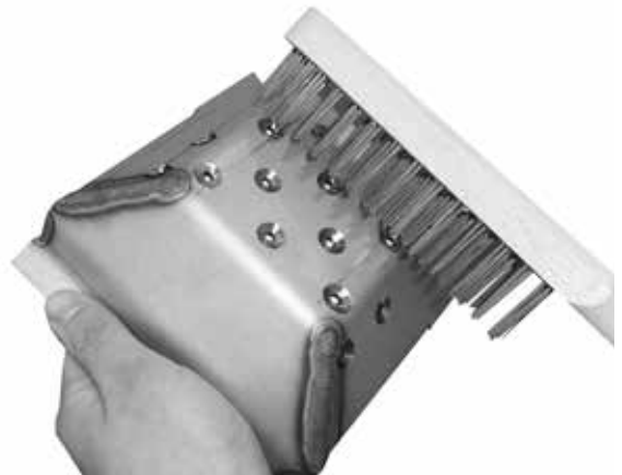
Beispiel: Reinigung der Brennkammer
