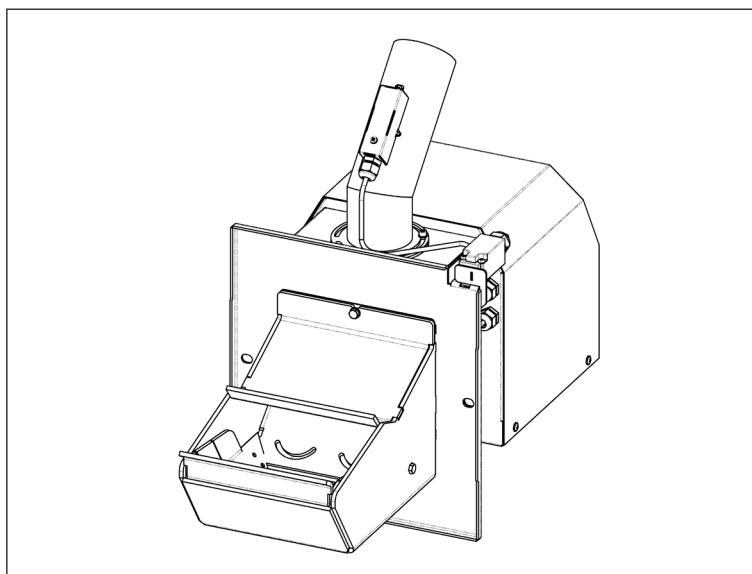
Clonu sekundárního vzduchu zabudujeme do hořáku v případě nastavení výkonu hořáku pod 30 kW.
