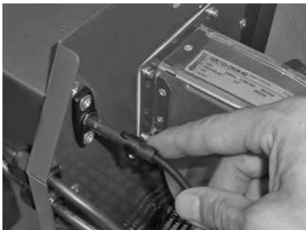
Rys. 6 - Fotokomórka - należy uważać na prawidłowy kierunek podłączenia - zaleca się czyszczenie przynajmniej raz w roku
