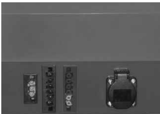
Rys. 12 - Palnik z dwoma 6-pinowymi przyłączami, lewe - zasilanie, prawe - czujniki, złącze 3-pinowe do podłączenia czujnika obrotów wentylatora kotła i gniazdo zasobnika
