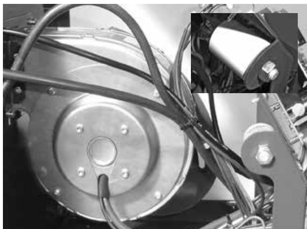
Rys. 9 - wentylator z czujnikiem obrotów i kondensatorem rozruchowym
