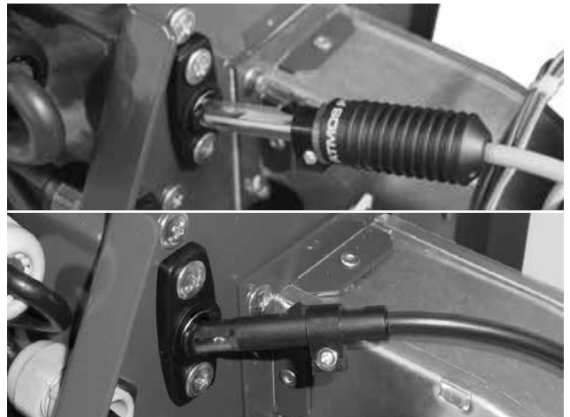
Abb. 4 - Photozelle - Vorsicht auf richtige Ori- entierung – es wird empfohlen, die Zelle mindes- tens einmal jährlich zu reinigen neue Fotozelle / alte Fotozelle
