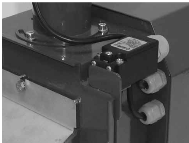
Obr. 8 - koncový spínač se speciálním dorazem
