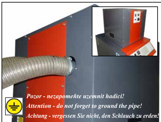
Napojení hadic na pneumatickou dopravu Pipe connection to the pneumatic feeding Anschlusschläuche für die pneumatische Ansaugung
