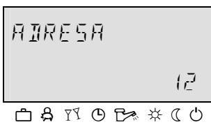
Pokojové jednotky komunikují s regulátorem datové, tzn. musí být připojeny datovým kabelem. Aby regulátor rozpoznal, ke kterému otopnému okruhu je jednotka určena, musí se nastavit BUS adresa jednotky.
