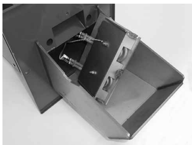
Rys. 4 - Zdemontowana pokrywa z grzałkami rozpalającymi
