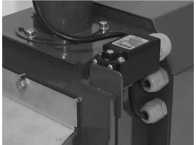
Abb. 8 – Endschalter mit Spezialanschlag
