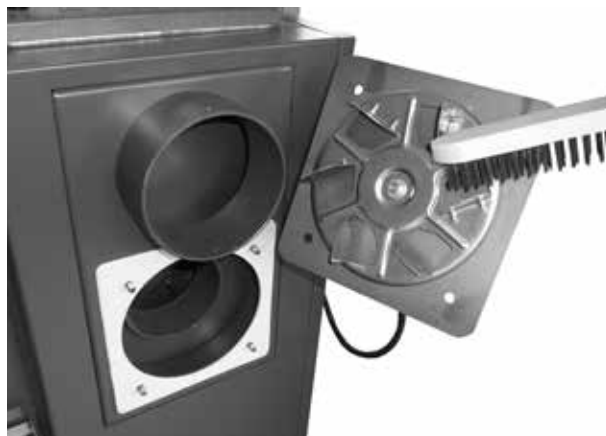
Exemplu de curățire a exhaustorului și verificarea garniturilor de etanșare a exhaustorului pe corpul cazanului
