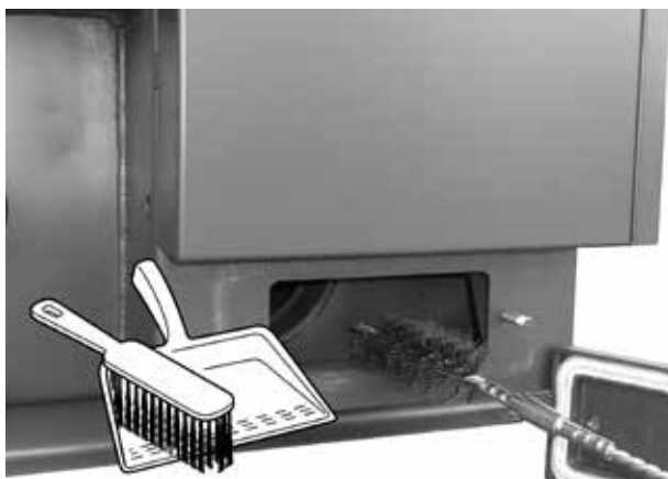
Exemplu de curățire a căii de evacuare gaze de ardere în parte superioară cu perie de sârmă și mâner metalic
