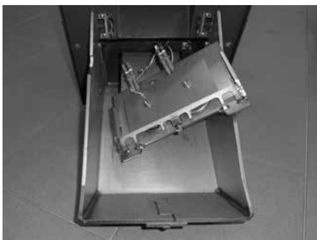
Rys. 4 - Zdemontowana pokrywa z grzałkami rozpalającymi
