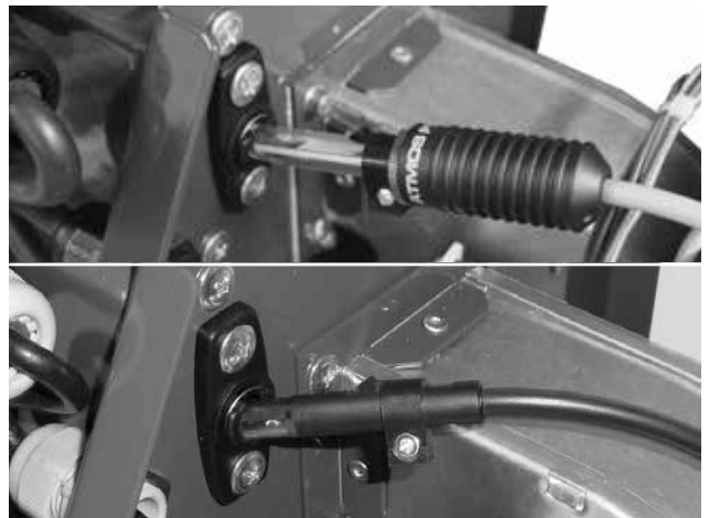
Abb. 6 - Photozelle - Vorsicht auf richtige Orientierung – es wird empfohlen, die Zelle mindestens einmal jährlich zu reinigen neue Fotozelle / alte Fotozelle
