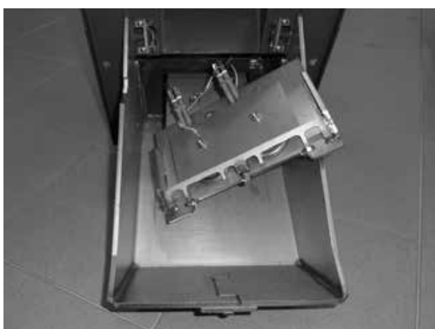
Obr. 4 - demontovaná deska se 2 zapalovacími spirálami
