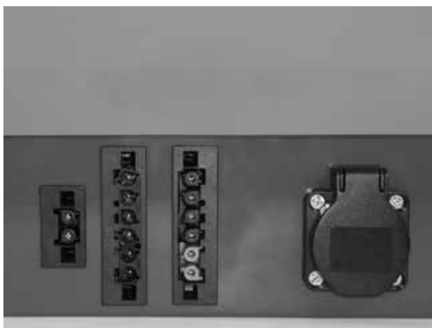
Obr. 12 - hořák - dva 6-pinové konektory, levý silový, pravý pro čidla, 2-pinový konektor pro přídavný kabel (R3 a R4) a zásuvka pro dopravník
