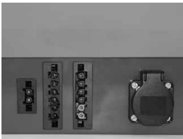
Obr. 12 - hořák - dva 6-pinové konektory, levý si- lový, pravý pro čidla, 2-pinový konektor pro při- davný kabel (R3 a R4) a zásuvka pro dopravník
