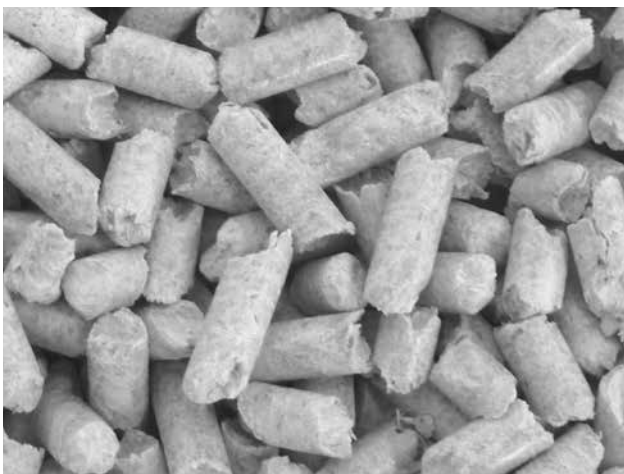
Obr. 17 - kvalitní dřevěné pelety - bílé bez černých teček (kůry)
