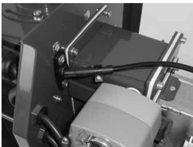
Obr. 6 - fotocela - pozor na správnou orientaci - doporučujeme minimálně jednou ročně očistit
