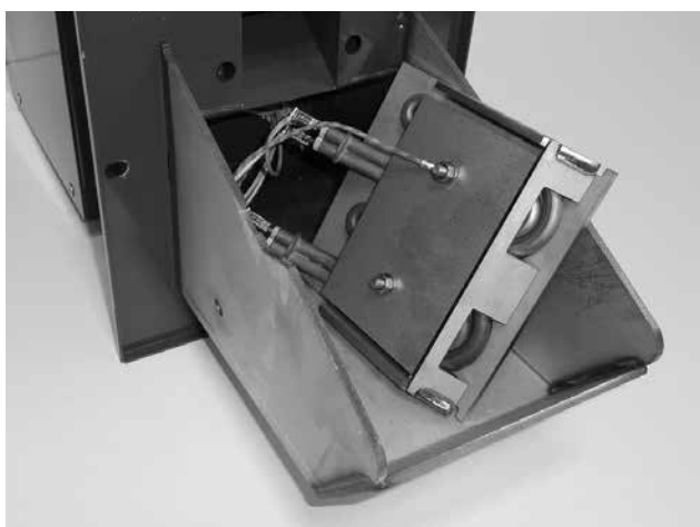
Rys. 3 - zdemonstrowana pokrywka z grzałkami rozpalającymi
