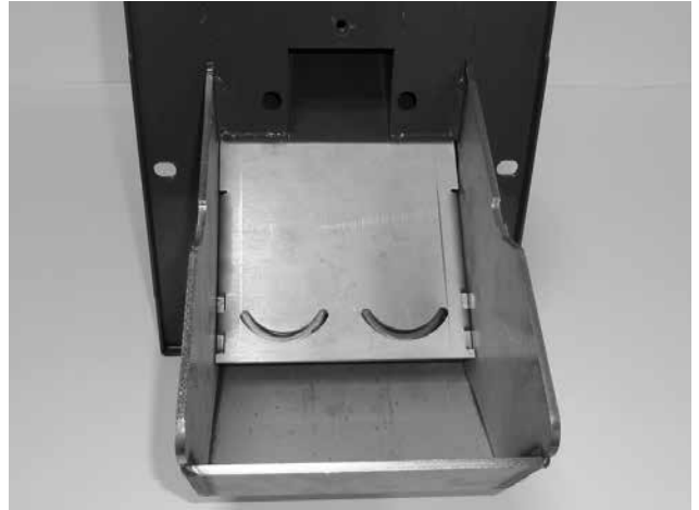
Abb. 2 - Abgedeckte Verbrennungskammer mit Öffnungen, hinter denen die Zündspiralen situiert sind
