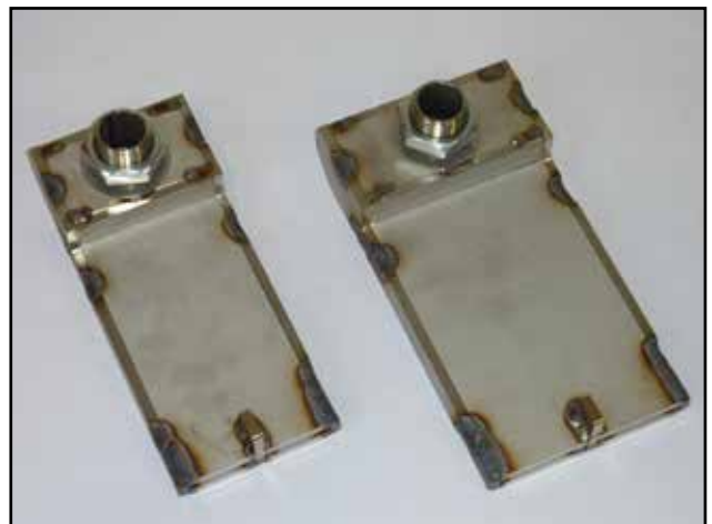
Kanal des pneumatischen Reinigungssystems mit einer Sicherungsmutter und Unterlegscheibe für die Brenner A25 und A45
