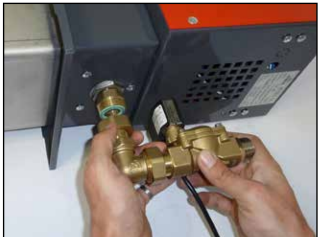
An den Brenner werden die Verschraubung mit dem Steuerelektroventil und Verbindungskabel angeschraubt
