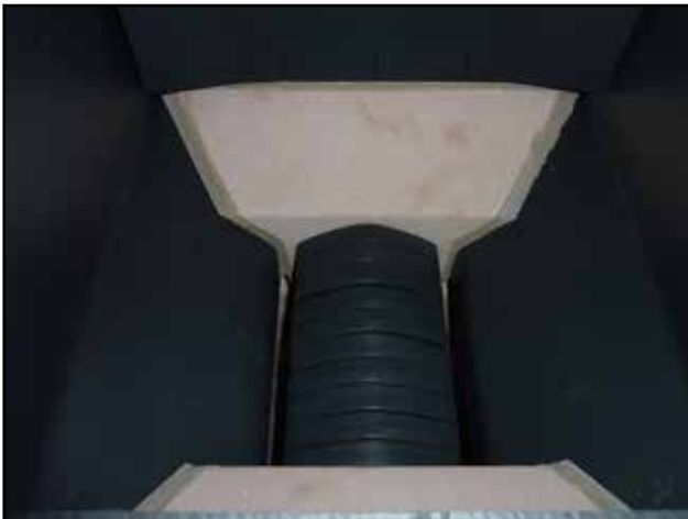
Beispiel des Vergasungsrostes für die Kessel KCxxS, CxxS, ACxxS ohne den speziellen zusätzlichen Rost
