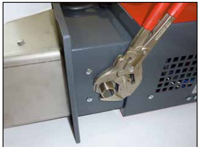
Die Sicherungsmutter mit der Unterlegscheibe ist festzuziehen
