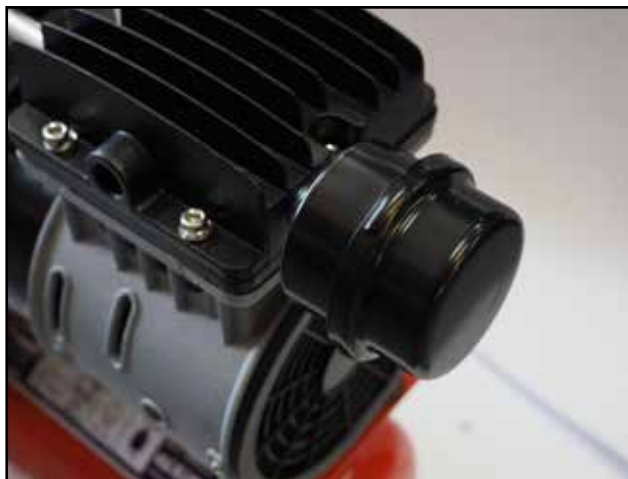
Auf dem Verdichter befestigter Saugfilter
