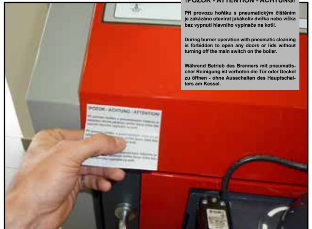
Aufkleber mit wichtigen Hinweisen (ACHTUNG – Während Betrieb des Brenners mit pneumatischer Reinigung...)
