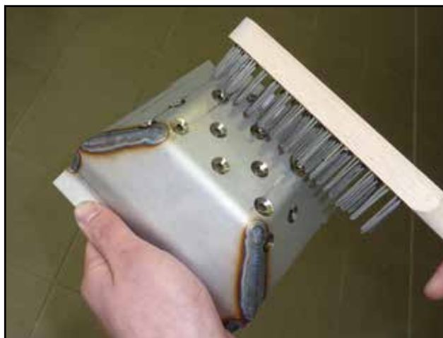
Reinigung der Brennkammer
