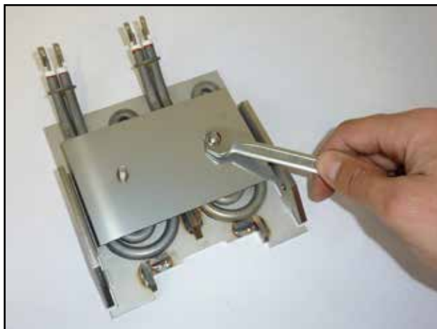
Die neue Platte der Glühspiralen ist aufzulegen und festzuschrauben
