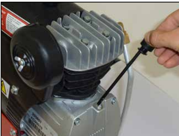
Prüfung des Ölstands im Verdichter
