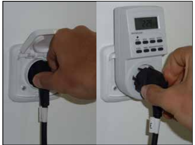
Das Verbindungskabel wird an die Wanddose angeschlossen u.z. direkt oder über die spezielle Schaltuhr für induktive Last 8 A Code: S0090 (Achtung – im Handel normal nicht erhältlich).
