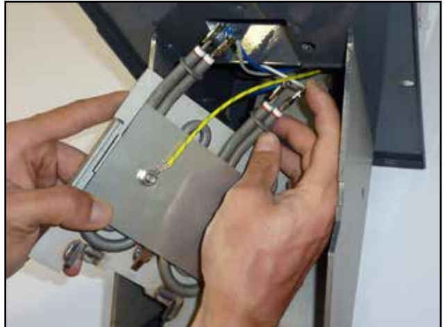
An jede Spirale werden die Stecker (weiß und blau immer gemeinsam auf einen Glühkörper) aufgesteckt
