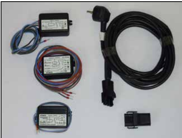
Module AD02, AD03 und AD04 (ausser PXxx, DxxPX) Verbindungskabel mit einem Stecker mit 3 Stiften (weiblicher Teil) und der selbstständige Stecker mit 3 Stiften (männlicher Teil)
