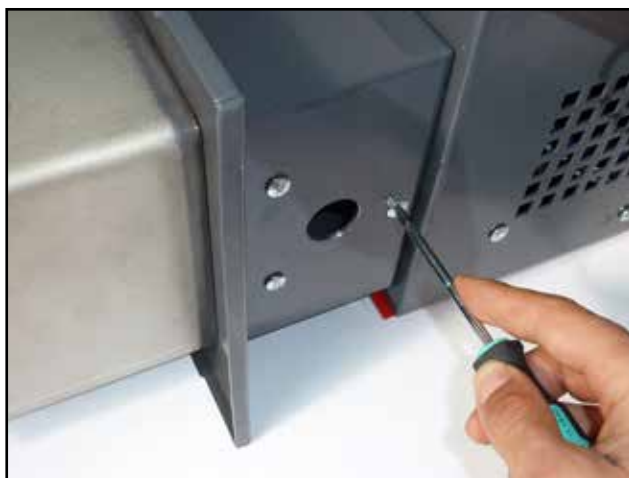
Die ursprünglichen Schrauben sind zurück zu bringen. Dabei muss man an festes Anziehen achten, um Ansaugen der Falschluff zu vermeiden
