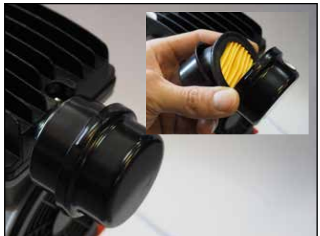
Reinigung des Verdichterfilters
