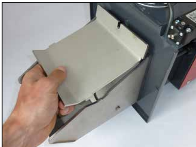
Povolíme a vyšroubujeme šroub M6, který drží kryt hubice hořáku a kryt sejmeme
