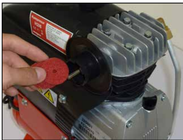
Ukázka čištění filtru kompresoru
