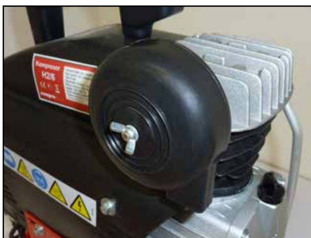
Foto sacího filtru našroubovaného na kompresoru
