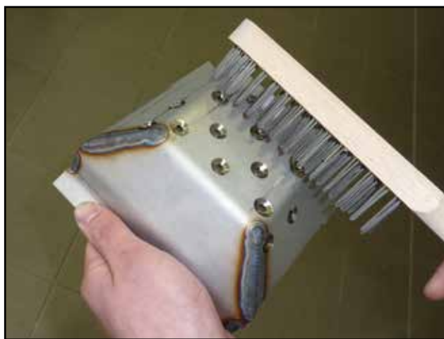
Ukázka čištění spalovací komory
