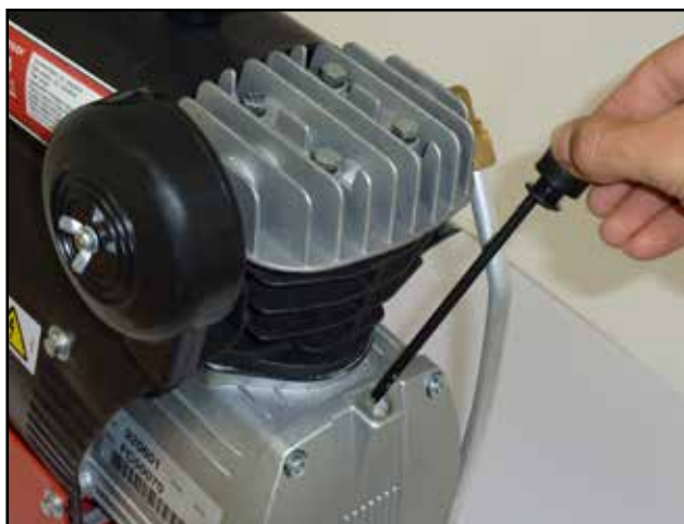
Ukázka kontroly olejové náplně v kompresoru
