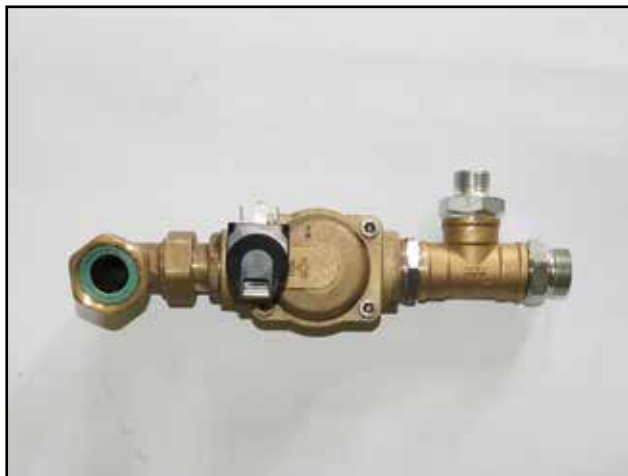
Beispiel der Komplettverschraubung (3/4") mit T-Stück (3/4" / 1/2") und dem Steuerelektroventil
