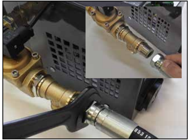
Es wird andere Ende des Verbindungsschlauchs (3/4“) mit einer Dichtung genommen und T-Stück fest anziehen das am Magnetventil verschraubt ist.
