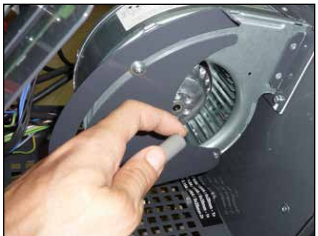
Reinigung (Ausblasen) des Laufrads des Druckventilators einmal pro Heizsaison
