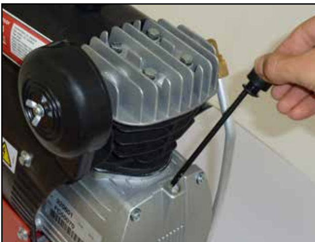
Prüfung des Ölstands im Verdichter
