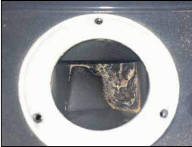
Zerkleinerte Pellets und hohe Staubmenge nach 3 Betriebsmonaten
