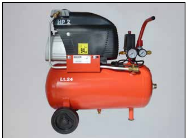
Verdichter in der für die pneumatische Reinigung angepassten Ausführung
