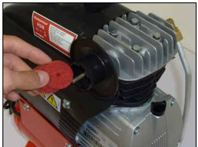
Reinigung des Verdichterfilters
