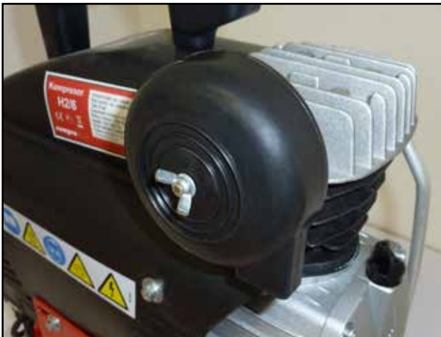
Auf dem Verdichter befestigter Saugfilter
