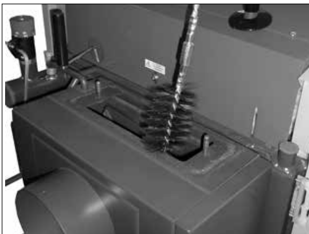
Vorführung der Reinigung des Rauchkanals mit Drahtbürste.
