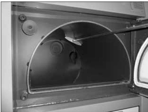
Die obere Nachlegekammer mit dem Schaber zu reinigen
